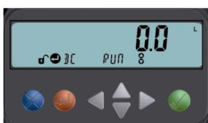
En état départ usine le cadran FLUXTRONIC® est paramétré en mode manuel.
