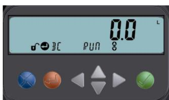
Im Auslieferungszustand ist die FLUXTRONIC® auf manuellen Betrieb eingestellt, sie befindet sich nun im Anzeigebetrieb. Diese Betriebsart dient zur manuellen Abfüllung, die Menge wird im Display angezeigt.
