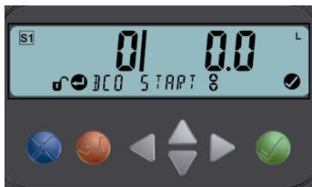
Ce mode permet le conditionnement automatique d'un volume préselectionné.
